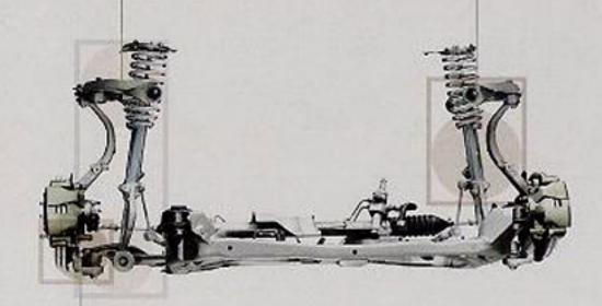
I LOWER A-ARMS UTILIZE DOUBLE BALL JOINTS FOR GREATER SUSPENSION-GEOMETRY CONTROL
